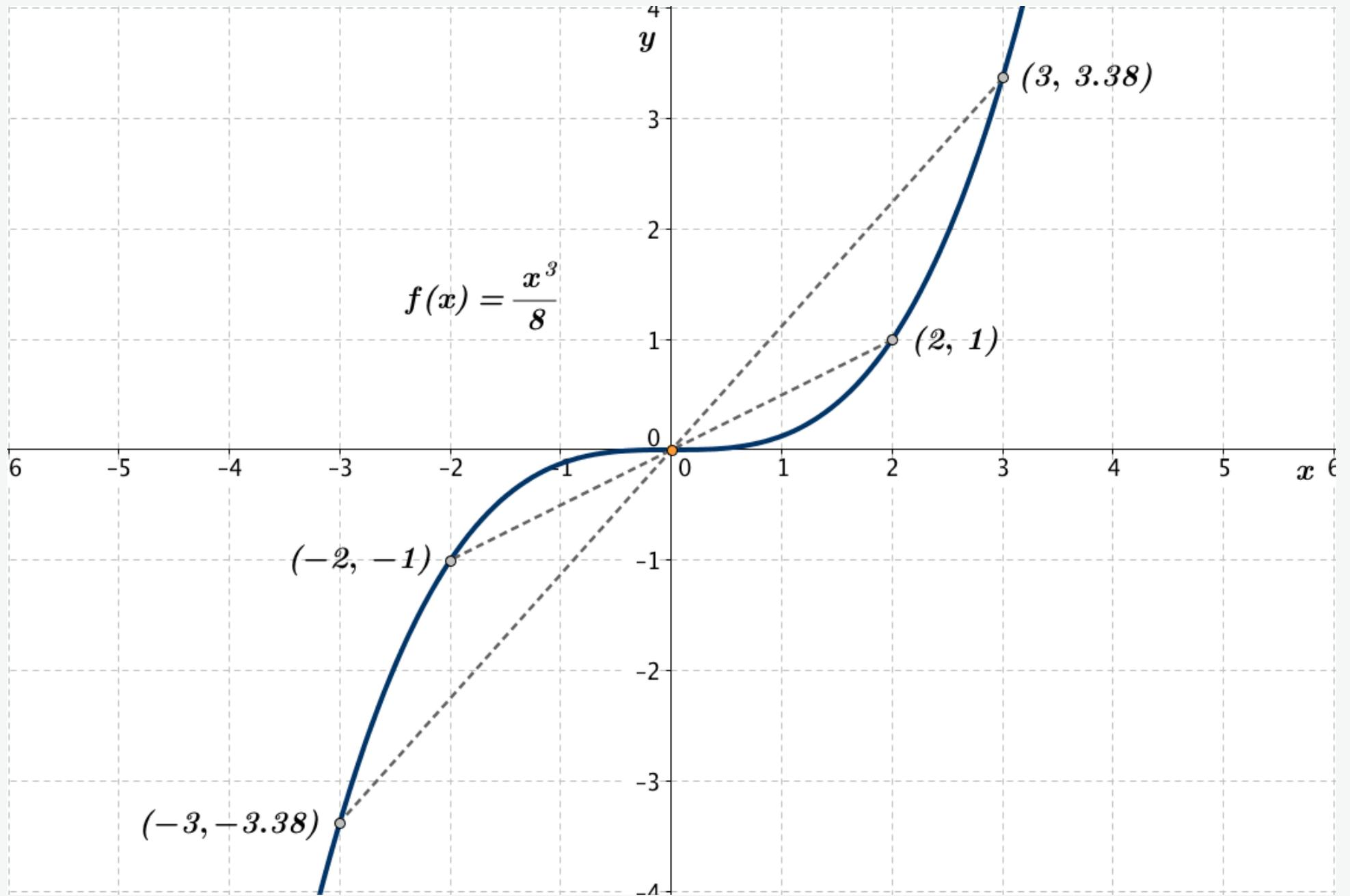
Abb. 1-2b: Die Funktion  $f(x) = x^3/8$  ist symmetrisch in Bezug auf den Punkt  $O(0, 0)$
