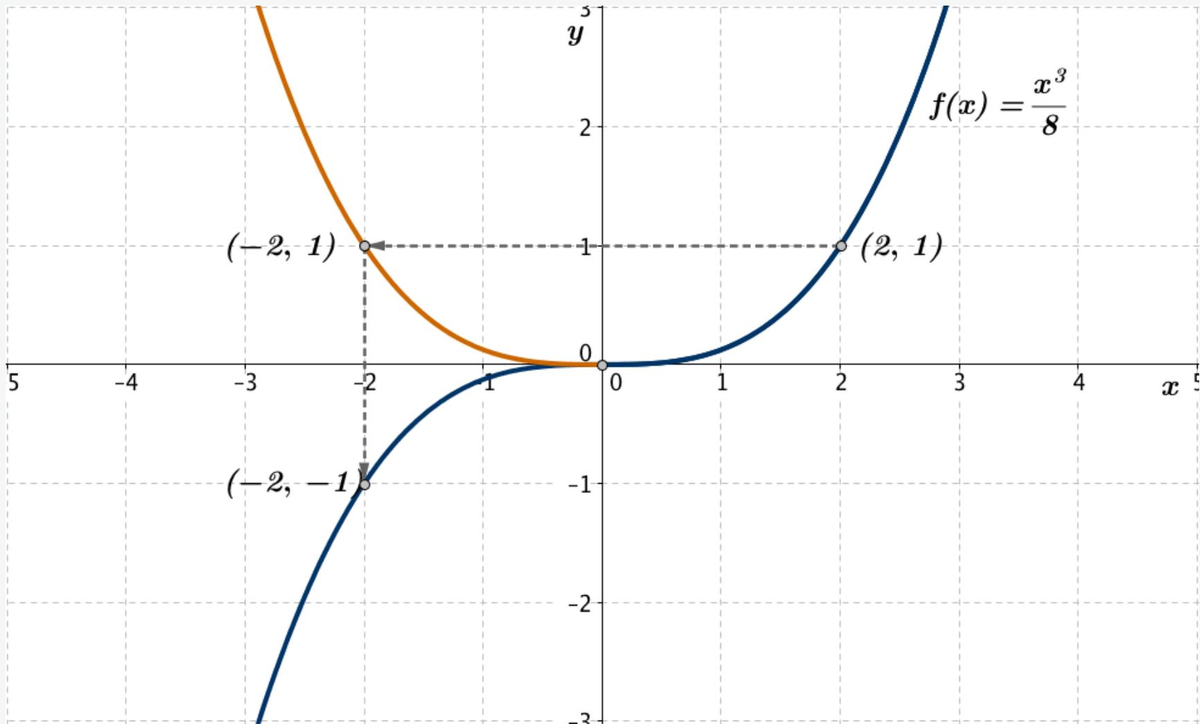
Abb. 1-3c: Darstellung des Graphen der ungeraden Funktion  $y = x^3/8$  als zwei aufeinander folgende Spiegelungen.
