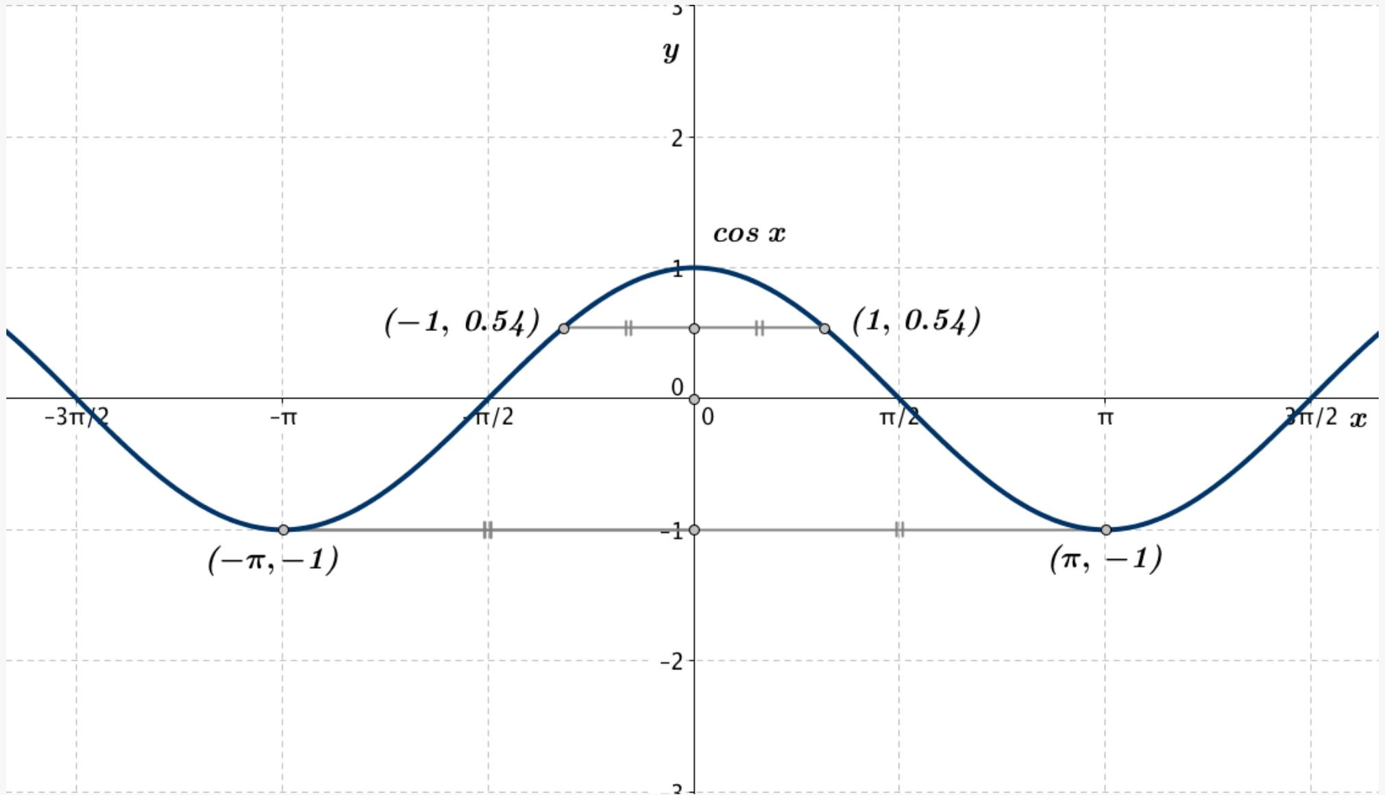
Abb. L8a-1: Die Funktion  $f(x) = \cos x$  ist gerade,  $f(-x) = f(x)$
