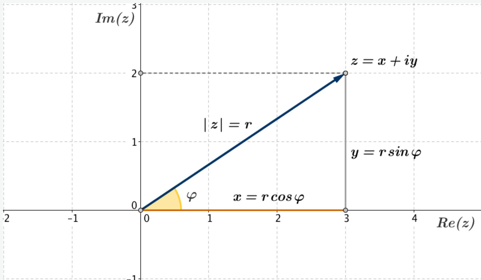
Abb. 1-2: Trigonometrische Form einer komplexen Zahl
