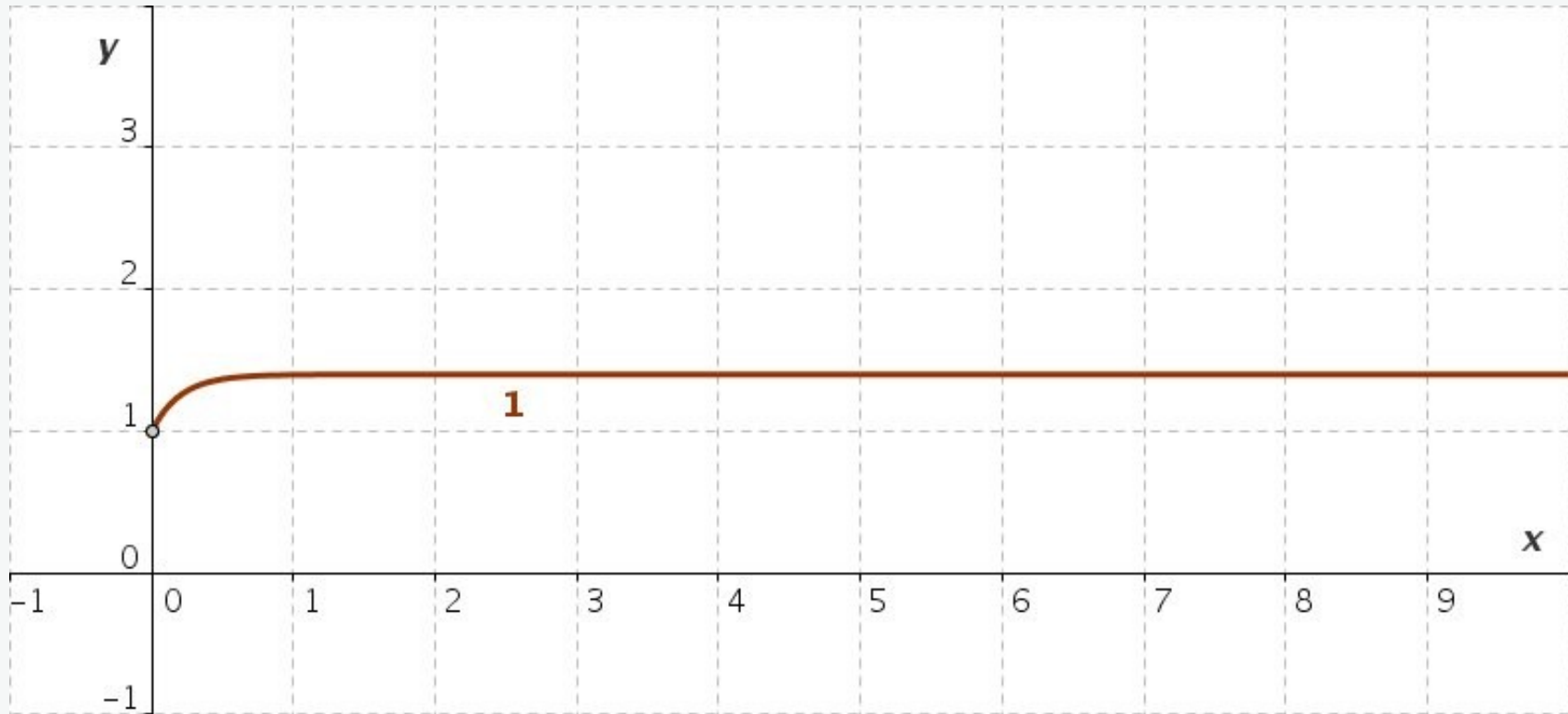
Abb. L8-1: Integralkurve der DGL y'' + 5y' = 0 mit y(0) = 1 , y'(0) = 2
