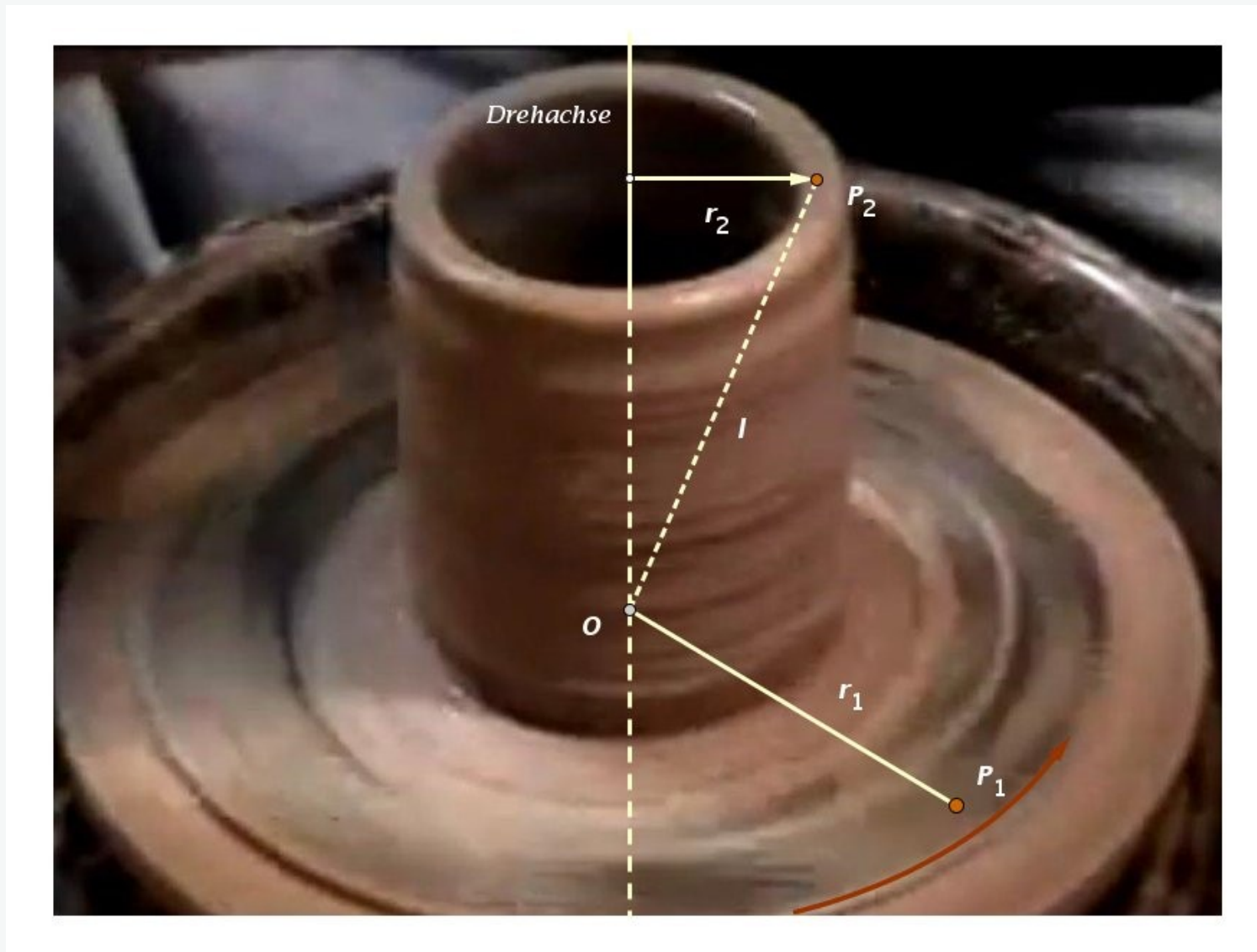
Abb. 3: Zur Darstellung des Unterschiedes zwischen dem Abstand zur Drehachse und dem Abstand zum Koordinatenursprung
