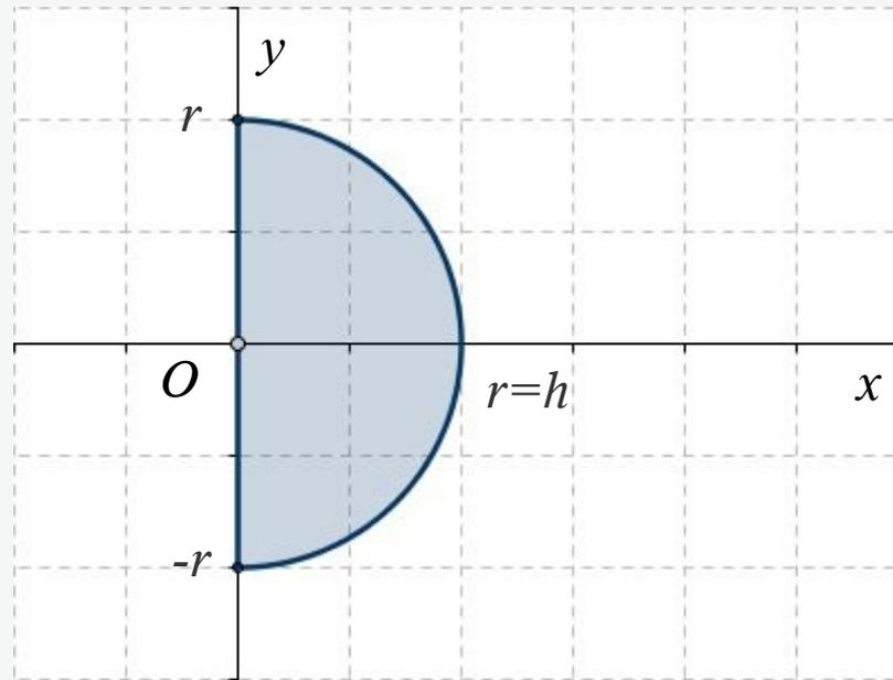
Abb. 15: Schnittfläche einer durch Rotation des Viertelkreises  $y = (r^2 - x^2)^{1/2}$  ( $0 \leq x \leq r$ ) um die  $x$ -Achse erzeugten Halbkugel
