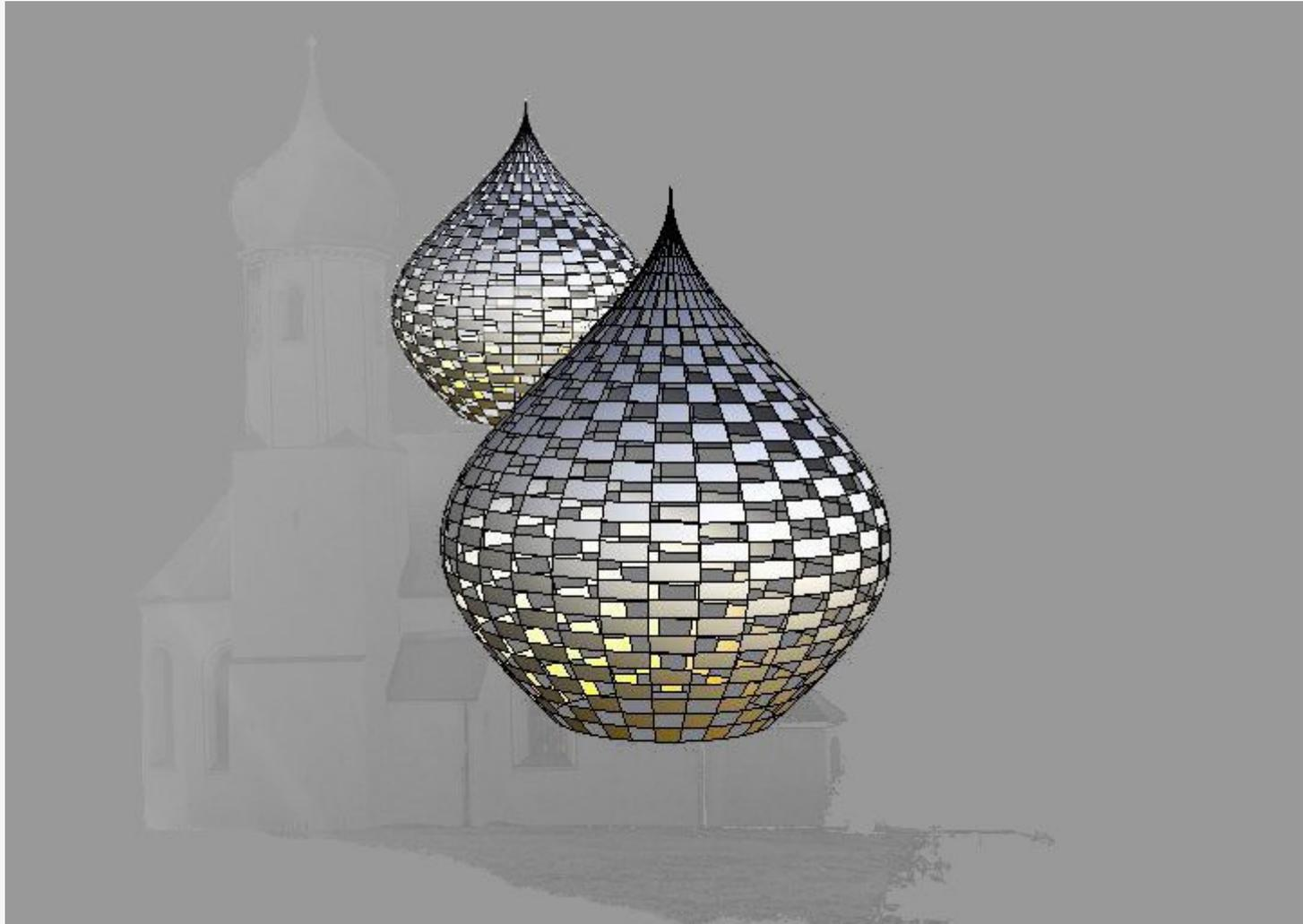
*Abb. 14b-3: Durch Rotation des Kurvenstücks  $y = f(x)$  ( $\varphi = 2\pi$ ) um die  $x$ -Achse erzeugter Körper*
