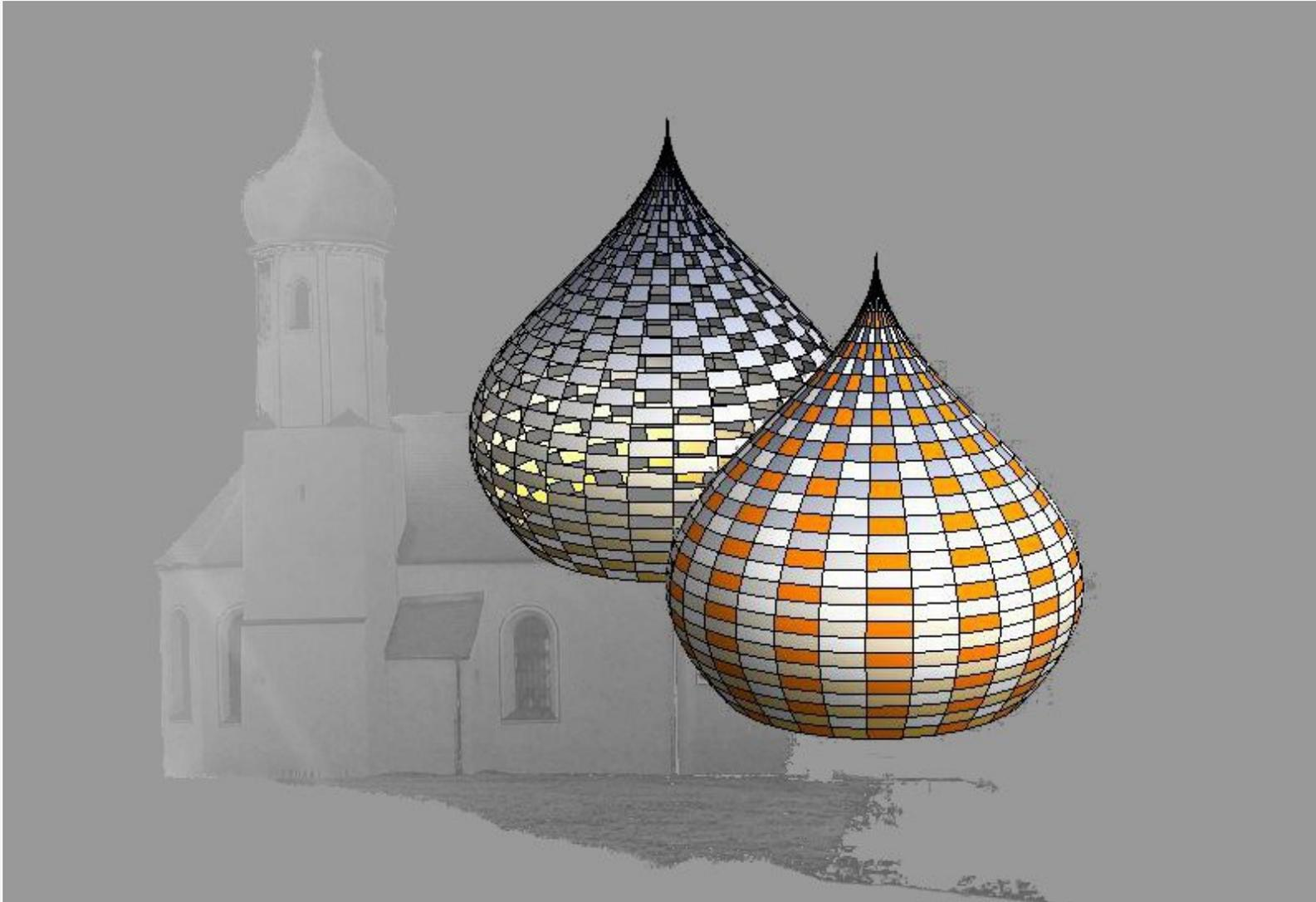
Abb. 14b-4: Durch Rotation des Kurvenstücks  $y = f(x)$  ( $\varphi = 2\pi$ ) um die  $x$ -Achse erzeugter Körper
