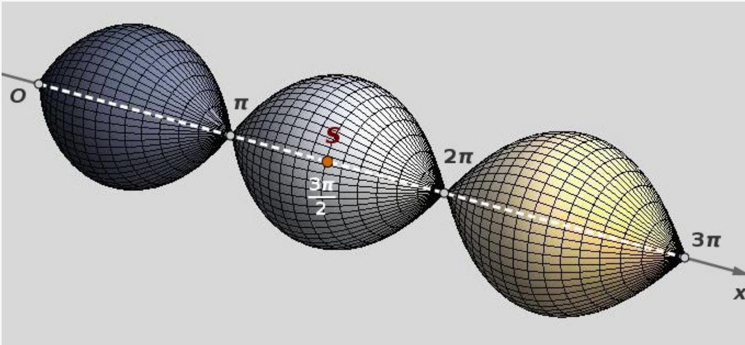
Abb. 13c-2: Durch Rotation des Kurvenstücks  $y = f(x)$  ( $\varphi = 2\pi$ ) um die  $x$ -Achse erzeugter Körper
