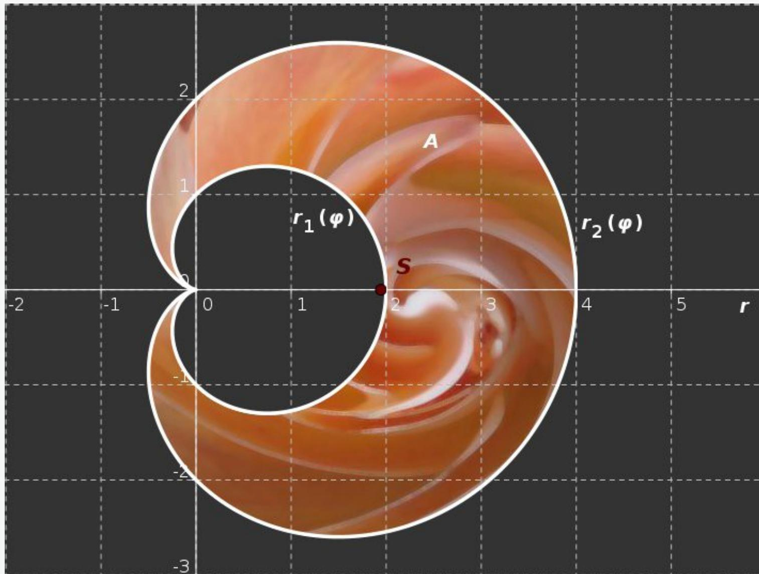
Abb. L10-2: Die von zwei Kardioden begrenzte Fläche mit eingezeichnetem Schwerpunkt
